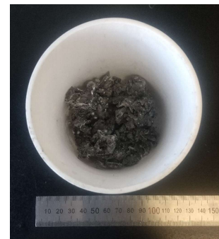
Fig. 1 Al-10 mass%Si 合金溶解後に回収したドロス試料の外観
